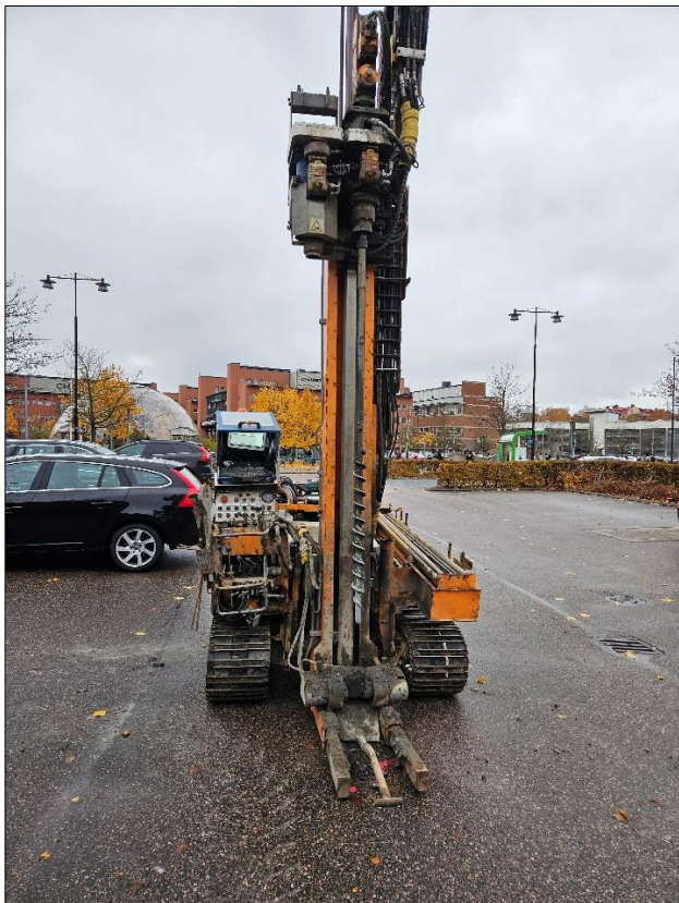
Figur 2. Jordprovtagning med borrbandvagn i provpunkt NC2305.
